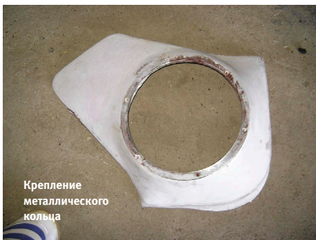
Обтяжка винилом и противоскрипная прокладка
