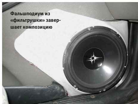
Готовая деталь, лёгкая, прочная и глухая
