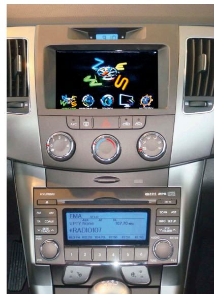
Hyundai NF Sonata. Штатное ГУ и управление подогревом сидений переезжают ниже в центральной консоли (для этого есть специальные рамки), экран занимает место наверху
