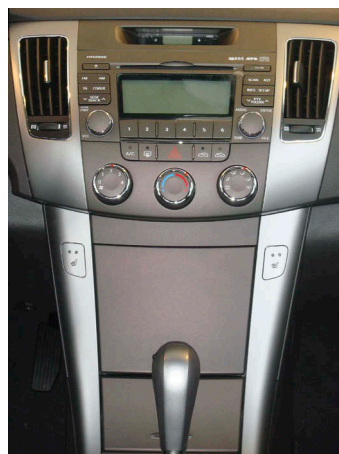
Hyundai NF Sonata. Штатное ГУ и управление подогревом сидений переезжают ниже в центральной консоли (для этого есть специальные рамки), экран занимает место наверху
